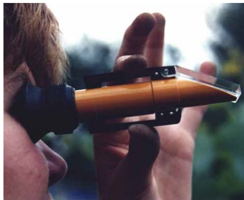
Suiker meten met de refractometer
